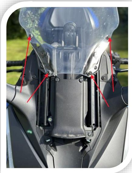
3. lösen Sie die 4 Innensechskantschrauben
