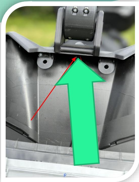
15. nun stellen wir den oberen Durchgang zum Halter her. Dabei bohren oder „dremeln“ wir das Loch so, dass der Stecker durchpasst (12mm x 6mm ) Den Mittelsteg musste ich hierbei entfernen.
