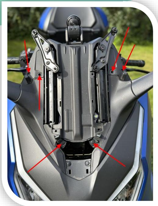
9. nun lösen wir die beiden Kreuzschlitzschrauben
