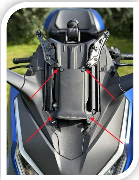
5. drücken Sie mit einem kleinen Schraubendreher die in der Mitte befindlichen Stifte der Plastiknieten vorsichtig hinein bis Sie ein „Einrasten“ spüren
